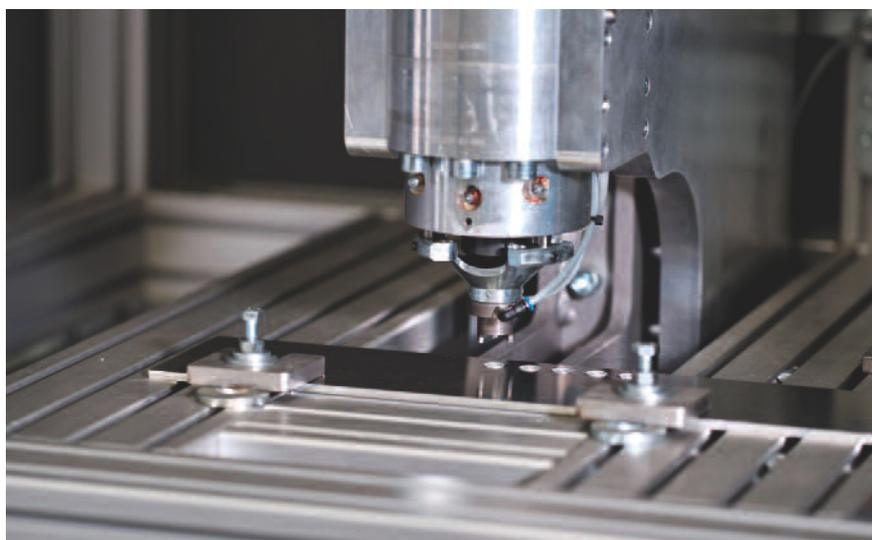
▲ Bild 4. Nicht rotierender Spannring, mit dem die Werkstücke fest aufeinandergepresst werden
