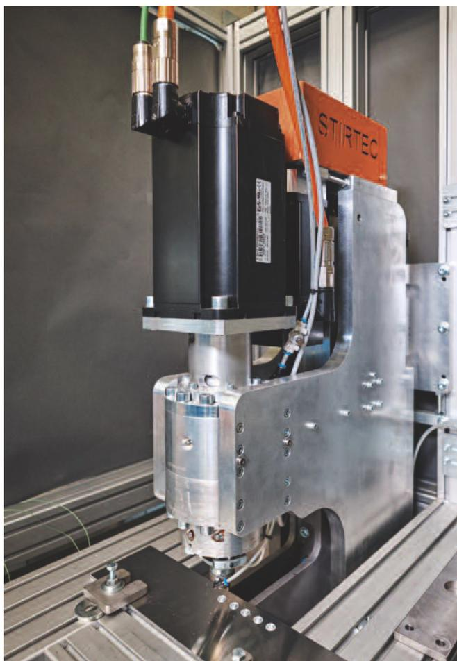
► Bild 2. Friction Stir Spot Welding: Punktschweißzange „D-SWG“ von Stirtec an einer Konsole
